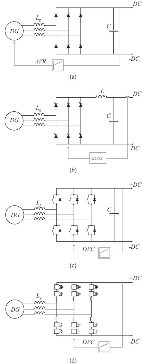
Fig. 2. 3-phase system configuration with different source side converters. (a) Diode rectifier. (b) Thyristor rectifier. (c) Multi-level active rectifier. (d) MMC active rectifier.
